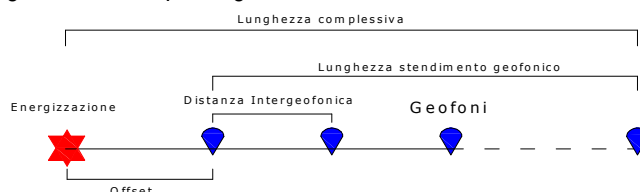
Fig.1 Schema illustrativo prova Masw
